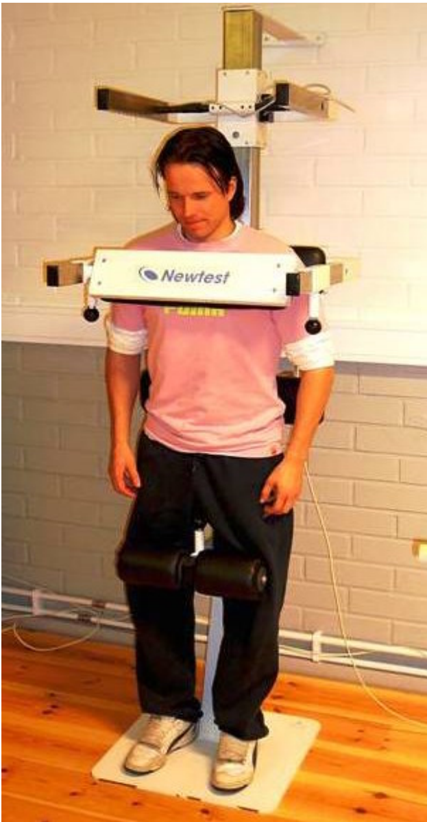
Kuva 3. New Test-vartalonkougistajien voimamittauslaite.
